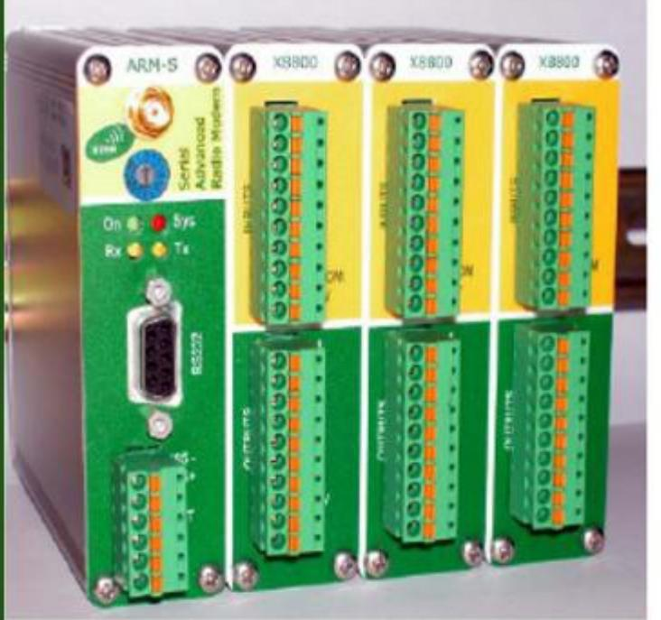
Yeni ARM-X radyo modem, kablolanmanın zor ya da pahalı olduğu, baraj, su istasyonları ve mekanik tesislerde, hatta hareketli olmayı gerektiren, araç, kreyin ve robot sistemlerinde, uzaktan kontrol, izleme, telemetri, veri transferi gibi uygulamalar için tasarlanmıştır. Bazı durumlarda PLC ya da G/C modüllerinin kullanımını bile gereksiz kılacak, tamamı ile "kullanıma hazır" bir yapı sunar.
